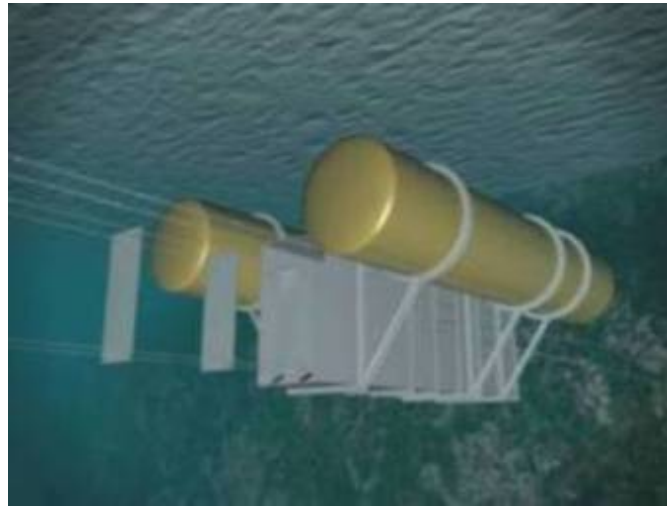
Figur 27. Skisse av Tidal Sails (Haugesund) sitt patenterte tideenergi anlegg.
