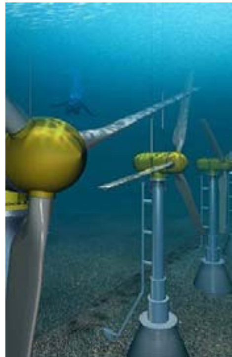
Figur 27. Skisse av Tidal Sails (Haugesund) sitt patenterte tideenergi anlegg.
