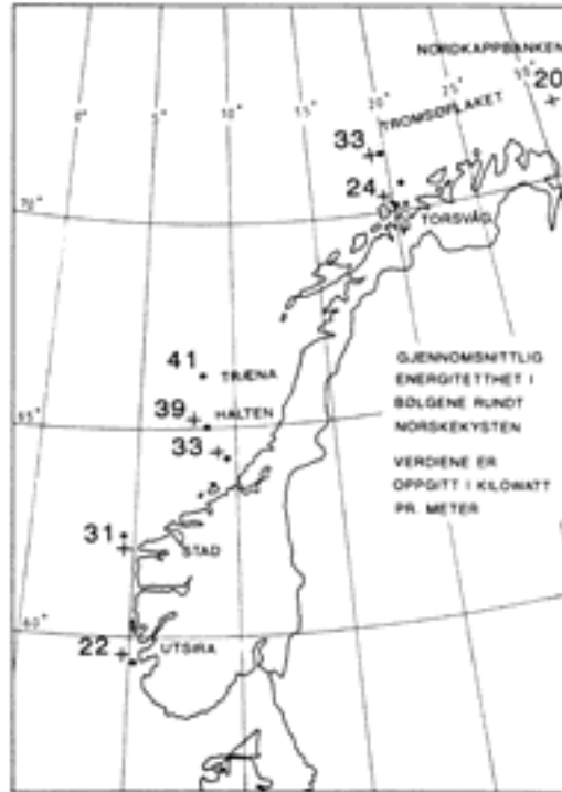
Figur 4. Beregna effekt frå bølger for nokre utaskjers punkt langs norskekysten (NHL 1990). Verdiane er effekt pr løpometer normalt på bølgefjorplantingsretninga (kW/m).
